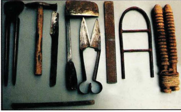
Resim 3: Naibant âletleri (İzmir Selçuk'lu Naibant Ahmet Ersoy'un naibant takımından) 1-Kerpeten, 2-Nallama, 3-Tırnak Keskisi, 4-Santranç, 5-Yele ve Kuyruk kıllarını kesmede kullanılan makas, 6-Tırnak Törpüsü, 7-Ağız ve Diş bakımında kullanılan ağırlık, 8-Yavaşa, 9-Diş Keskisi
